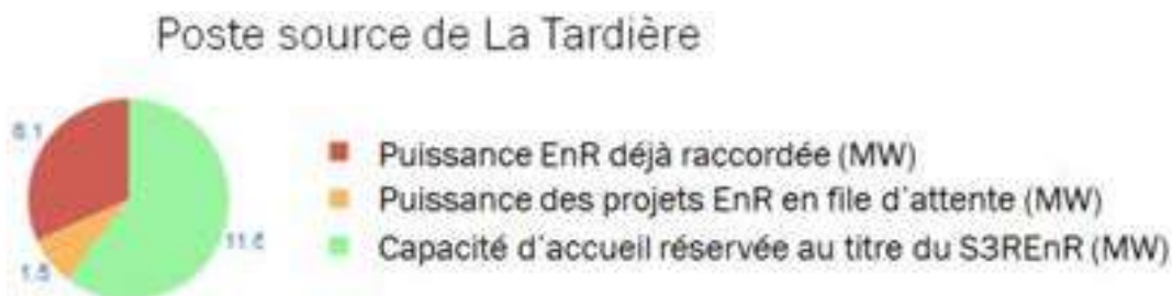
Figure 53 : capacité d'accueil des postes source du territoire
